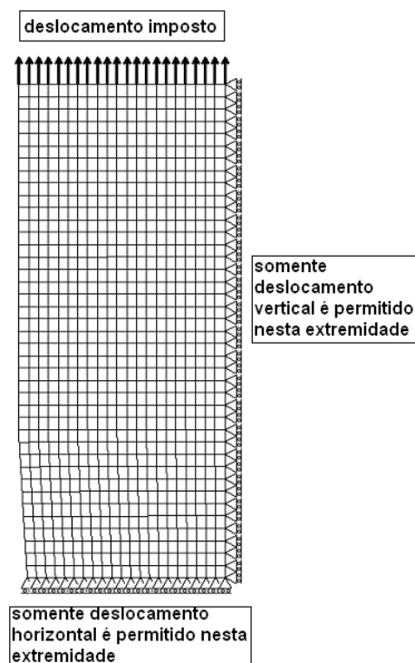
Figura 10: Esquema do modelo numérico que representa o ensaio de tração
